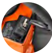
Automatická parkovací brzda integrovaná v ovládacích páčkách
